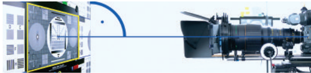
Korrekt eingerichtet: planparallel und ausschnittsgenau.
