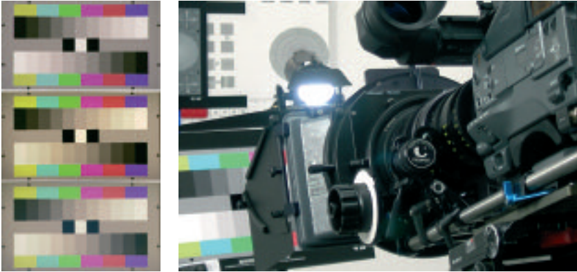
Unterschiedlicher Farbgang zweier Optiken (links). Gegenlicht knapp ausserhalb des Bild-caches produziert Flare (rechts). Fotos: Britta Kastern
