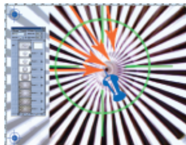
Abweichung über vier Brennweiten: die Mitte läuft bei zunehmender Brennweite akzeptabel nach rechts aus. In Photoshop können die deckungsgleich fixierten Ebenen beurteilt werden.
