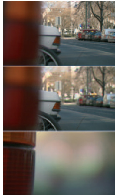
Fujinons HS 18x5,5mm ist praktisch „atemlos“: die innenfokussierte Optik pumpt nicht mehr.
