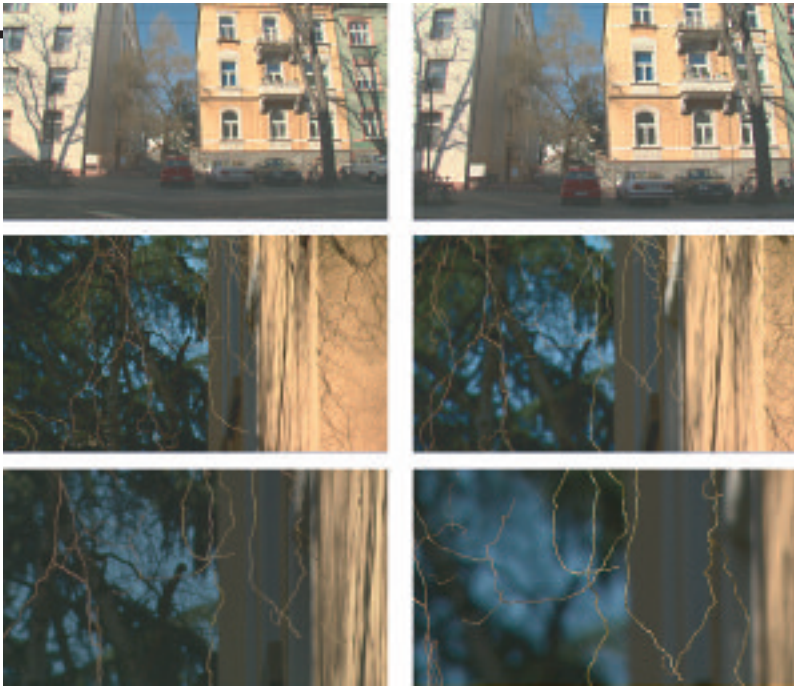
Die Bildwinkel im Vergleich: links die Bilder der HS 16x4,6 - total, bei 74mm und mit Zweifach-Konverter, rechts die der HS 18x5,5mm. In der Mitte mit dem langen Ende bei 100mm.
