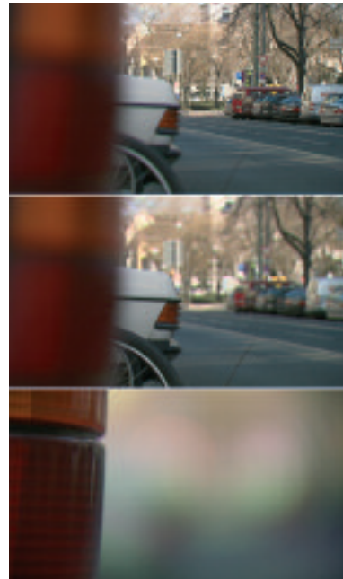
Fujinons HS 18x5,5mm ist praktisch „atemlos“: die innenfokussierte Optik pumpt nicht mehr.
