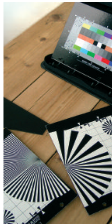
Der unentbehrliche Siemensstern muss zusammengesetzt werden: er liegt dem HD Set Kit in zwei Teilen bei. Foto: Bahman Kormi
