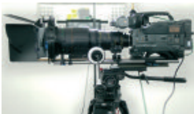
HDW 750P mit HAe 12x9,5 Zubehör: etwa 25 Kilo müssen auf den Horizon-Stativkopf abgetragen werden.
