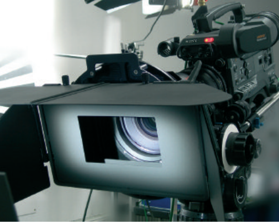
Das Kompendium von Chrosziel – hier mit Formatmaske – verhindert das Eindringen von Streu- und Gegenlicht.
