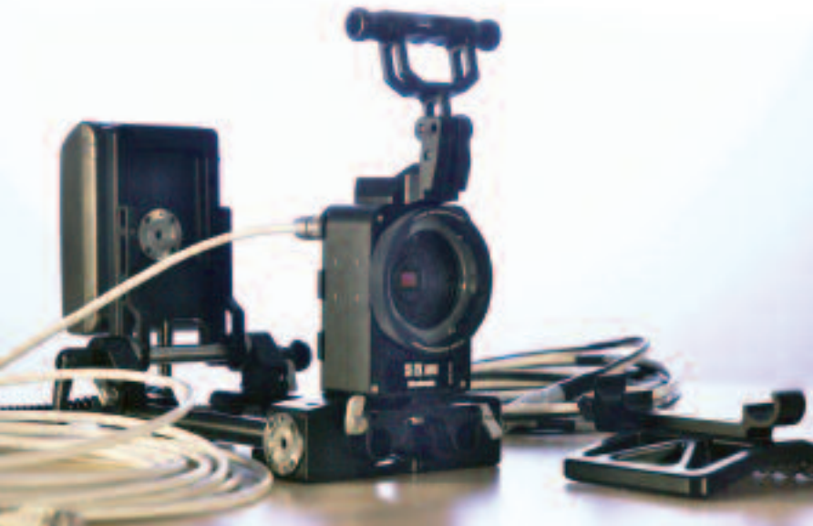
Die SI-2K Mini auf 15mm Stützgestänge und dazu die 15mm Aufnahmen für Zubehör und Shoulderpad.
