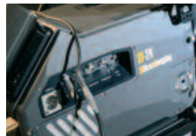
Kamerarechts: gängige LEMO INs&OUTs für 12V/5V Zubehör, Kontrolle und ON/OFF Schalter.
