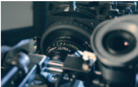
Rechts ausgelegter elektronischer Sucher und 14mm Arri Ultra16 mit Arri Kompendum. Alles kompatibel.
