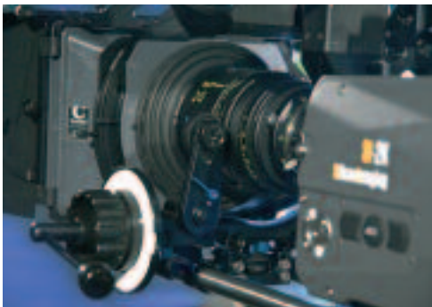
Der optische Sucher in B4 Ausführung mit 20mm Digi-Prime und Kompatibilität zu Chrosziel auf 19er Stützrohr.
